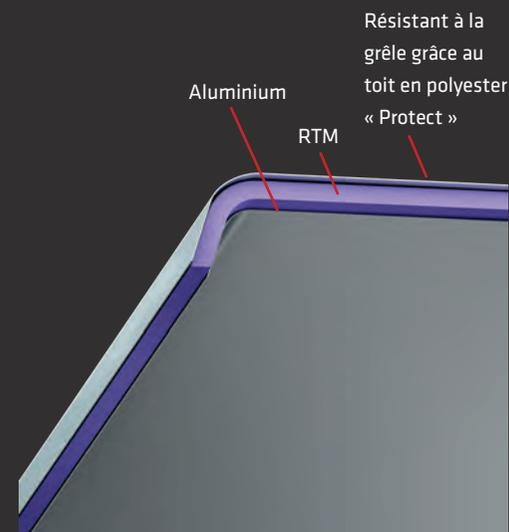
Malibu Van à toit relevable hybride avec le meilleur concept d'isolation de la catégorie, de construction sandwich et avec un faible poids propre
