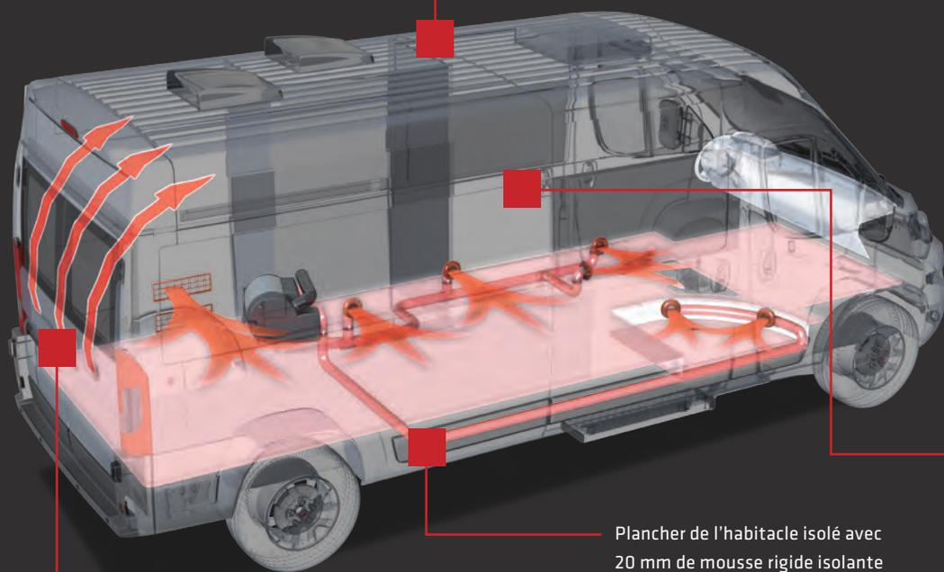
Paroi arrière/portes arrière : revêtement sans ponts thermiques avec des matelas isolants en polyuréthane de 20 mm d'épaisseur
