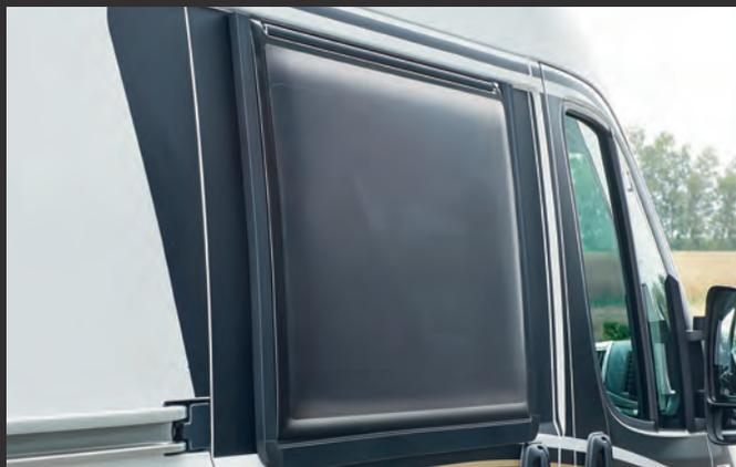
Baies Malibu Premium avec cadres tout autour et double système d'étanchéité comme protection contre la pluie et les projections d'eau, sécurité renforcée contre les effractions et bruits de la route réduits (pas aux hublots et baies arrières)
