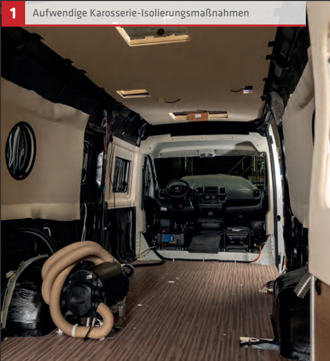
2 Kältebrückenfrei ausgekleidete Seitenwände und Karosserieholme
