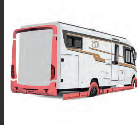
8 Telaio posteriore composto da 4 parti
