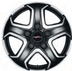
Optional: cerchi in lega da 16" per Fiat Ducato telaio f40 heavy / telaio f35 light in combinazione con cambio automatico
